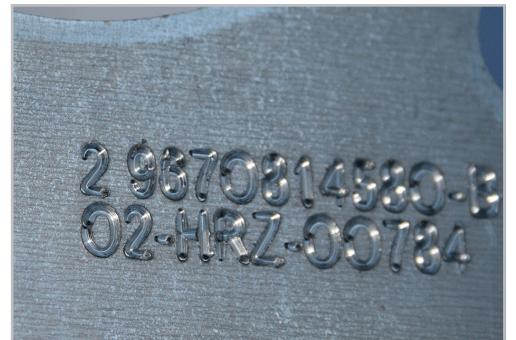
Part marking Detalle marcado de piezas
